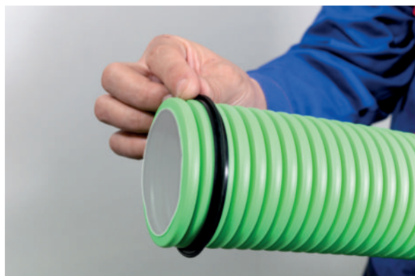
2) Do 2. nebo 3. drážky nasadíme těsnicí kroužek.
